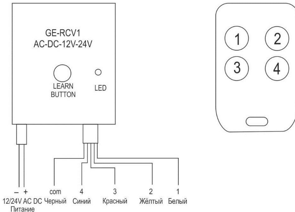
Рис. 1 Маркировка выводов приемника и нумерация клавиш пульта RT-4.
