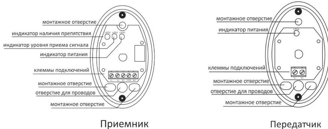
Рис. 1 Расположение компонентов передатчика и приемника
