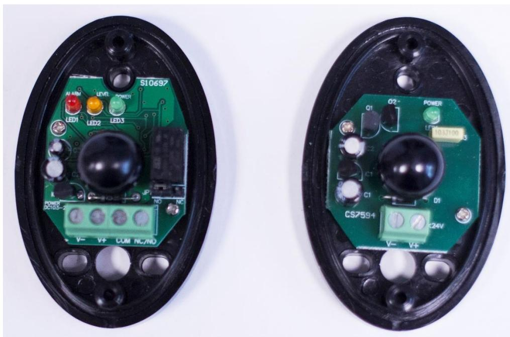
Рис. 2 Фотография фотоэлементов.
