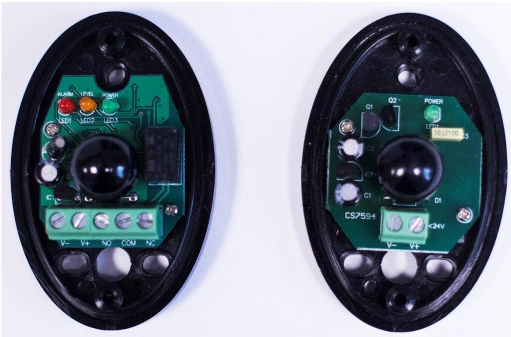
Рис. 4 Фотография фотоэлементов.
